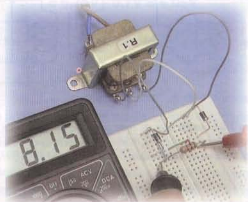
Figura 7.53. Midiendo el voltaje de salida
